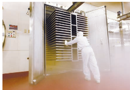
素材を8時間ほどかけて凍らせる凍結庫＝岡山県里庄町の里庄第二工場
