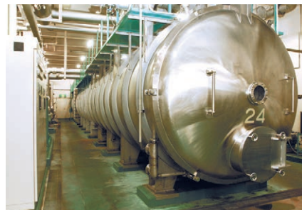
凍った素材を乾燥させる世界最大級の真空乾燥機＝岡山県里庄町の里庄第二工場、以上3枚は天野実業提供
