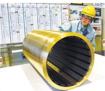
船舶などで使うゴム軸受け。内側にゴムをはった金属筒の中で、水を潤滑剤に推進軸が回転する。広島市安佐北区
