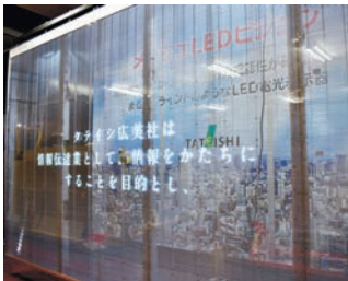
タテシ広美社が自社開発したメッシュLEDビジョン。後ろが透けて見える＝府中市河南町
