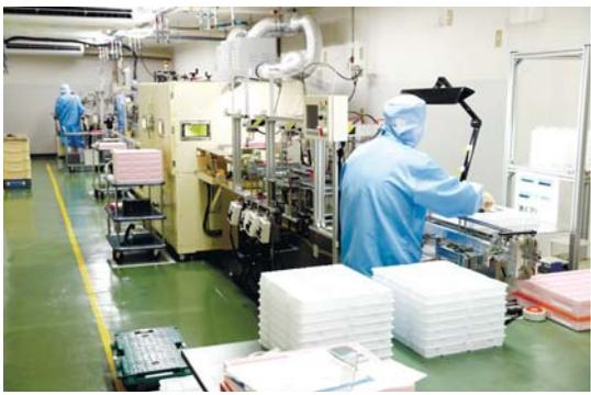
液晶パネルの仕上げを行う自社製機械
